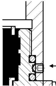
Sicherungsschraube mit Innensechskant M4
