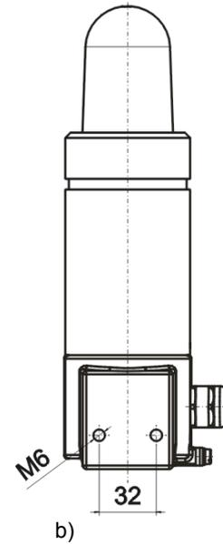
3.2.1 Direktmontage der Blitzleuchten am Anschlussgehäuse möglich
